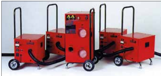
Hochleistungstrocknungsanlage bestehend aus einem Adsorptionstrockner und vier Turbinen für die Trocknung der Estrichdämmung bis zu ca. 200 m²
